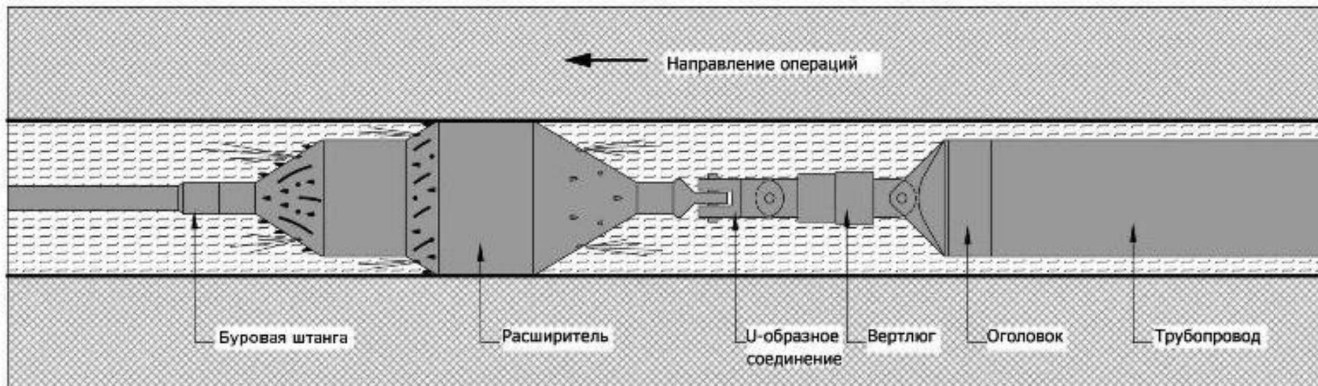
Рисунок 8.6– Сборка буровой колонны для протягивания трубопровода
