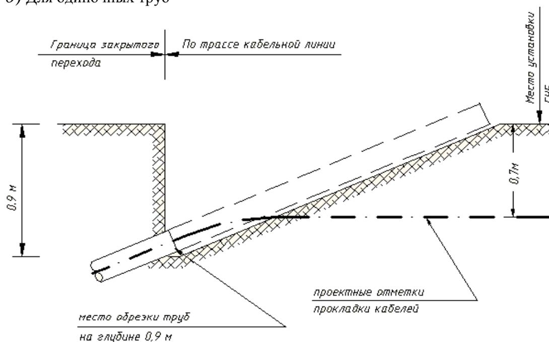
Рисунок 7.5 – Варианты шурфов для вывода кабелей из перехода
