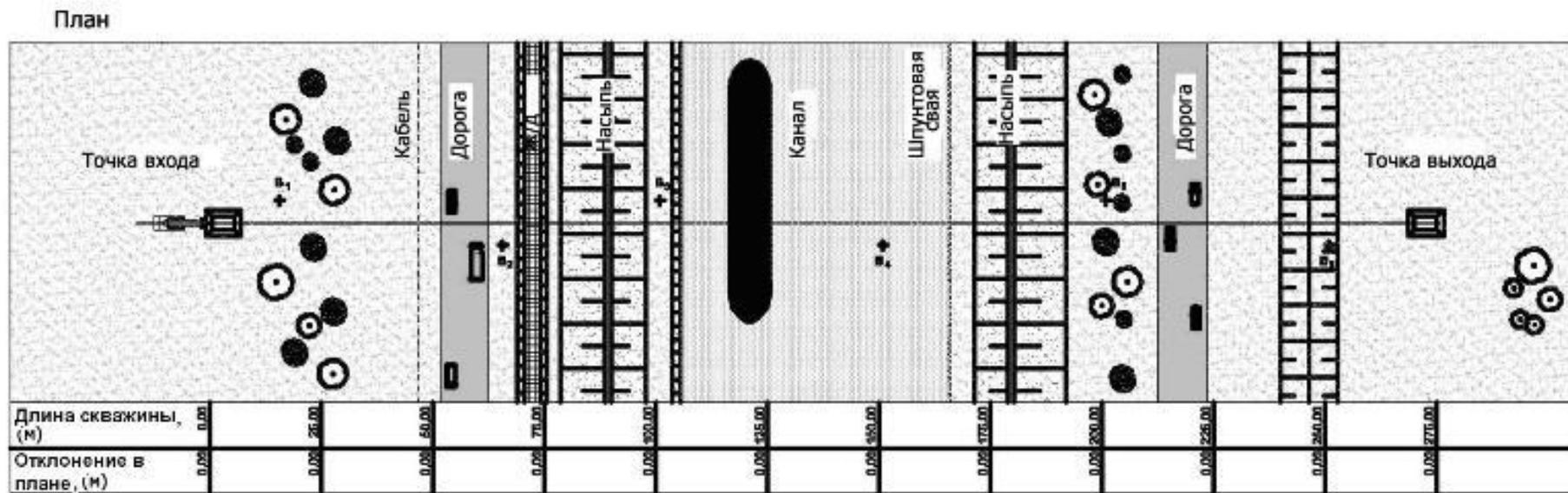
Рисунок А.1 – Продольный профиль и план закрытого подземного перехода сооружаемого методом ГНБ
