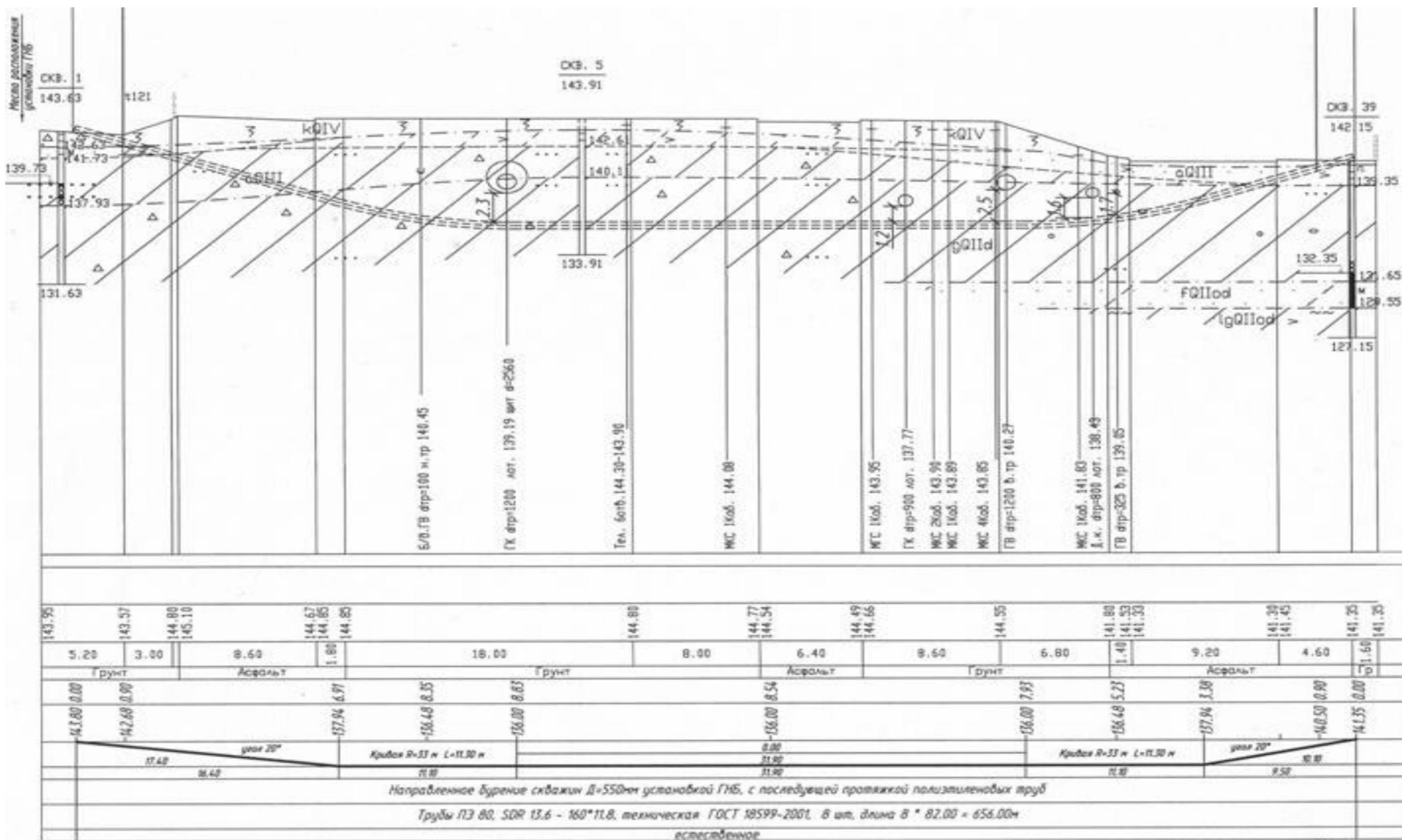
Рисунок 7.1 – Пример построения продольного профиля трассы скважины ГНБ
