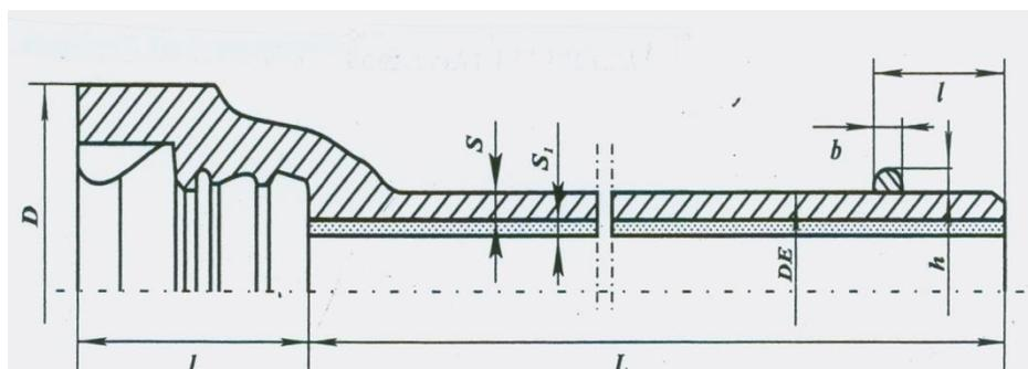
Рисунок Г.1 – Труба раструбная под соединение «RJ»
