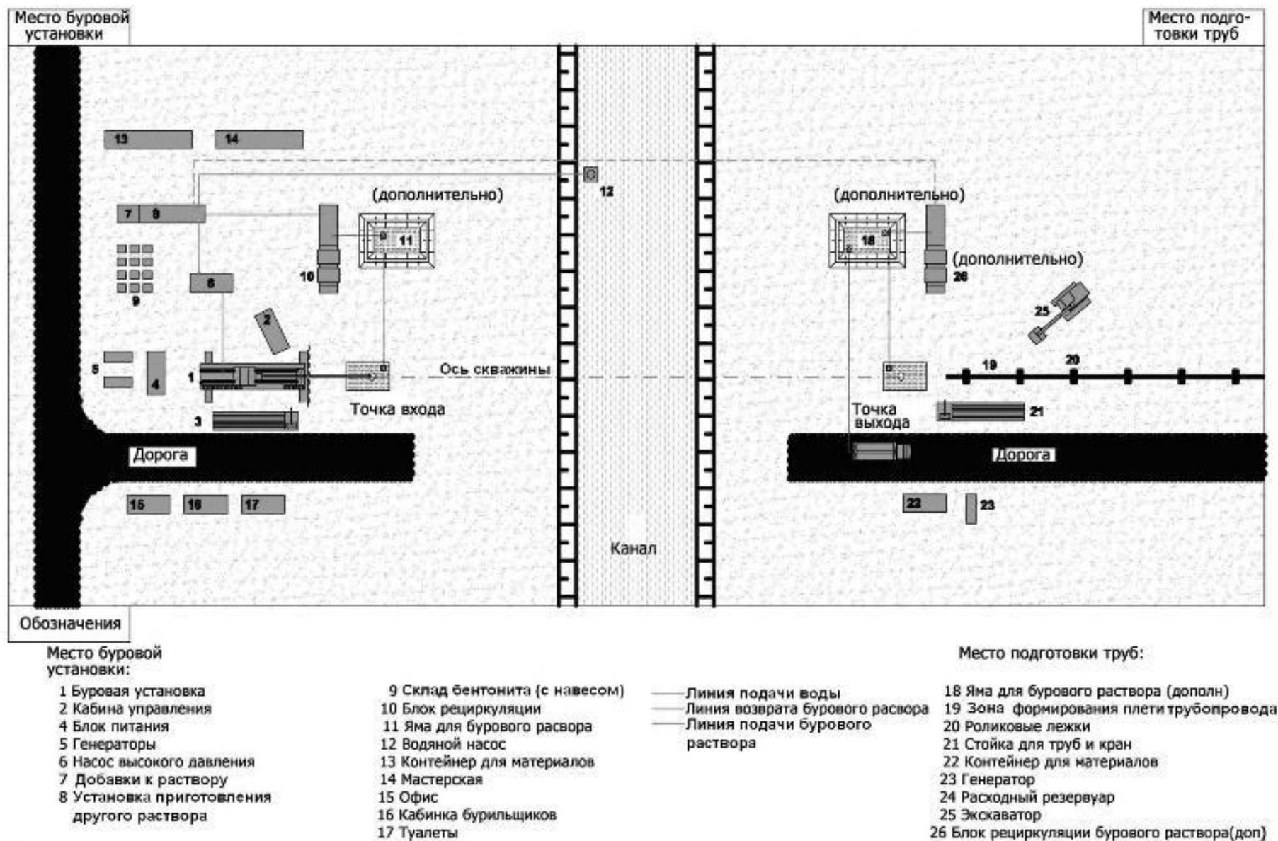
Рисунок 8.1 – Схема расположения оборудования на стройплощадке
