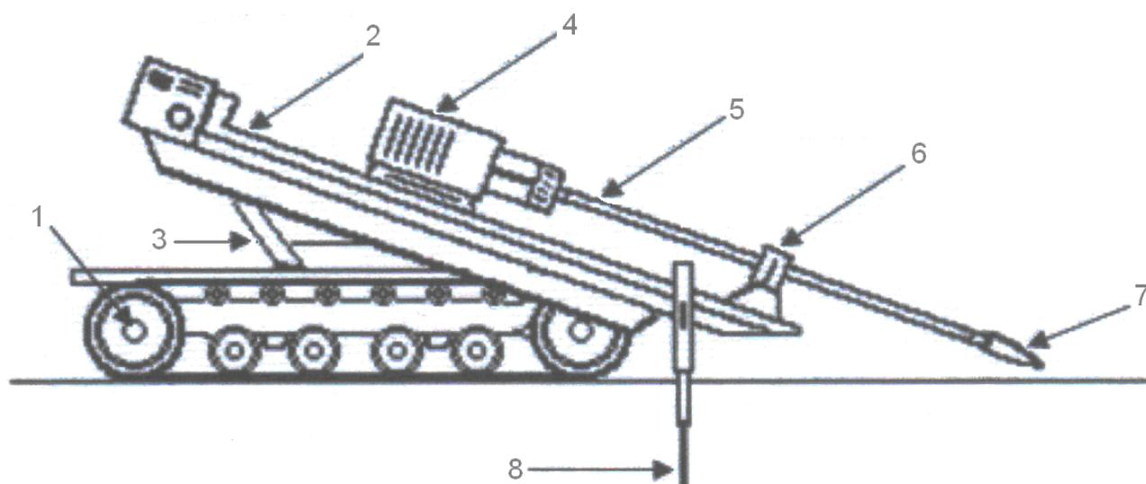
1 – ходовой механизм (чаще гусеничный с кабиной оператора); 2 – буровой лафет (оснащается сменной кассетой со штангами); 3 – гидравлическая система регулировки угла бурения; 4 – приводной механизм вращательного бурения и поступательного движения; 5 – буровая колонна из инвентарных штанг; 6 – гидравлическое зажимное устройство; 7 - буровая головка; 8 – фиксирующее анкерное устройство (анкерная плита)
