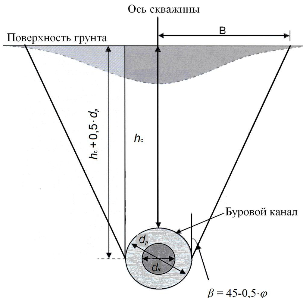
Рисунок 7.2 – Распределение осадок поверхности для скважин ГНБ
