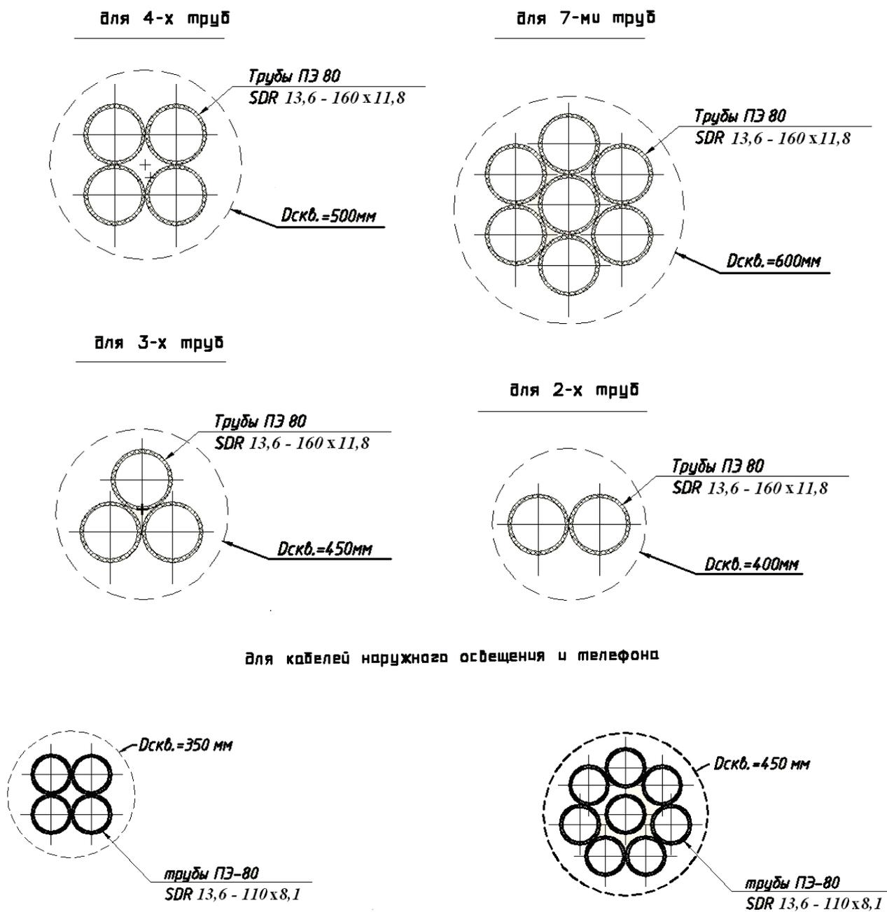
\*\*\* Примечание - Диаметр скважины *Dскв.* указан с учетом 20 % запаса относительно протягиваемых труб
